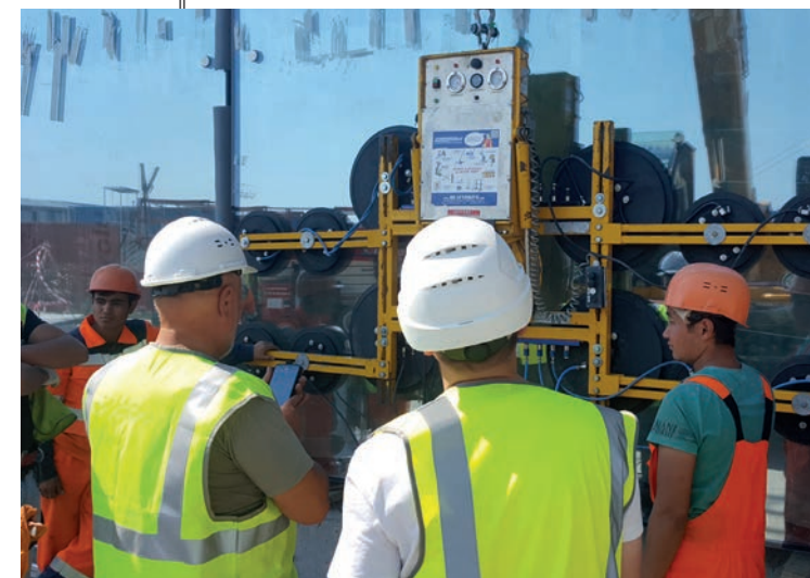
Instruksjon på stedet: VSG 1500 KH vakuumsugesystem
